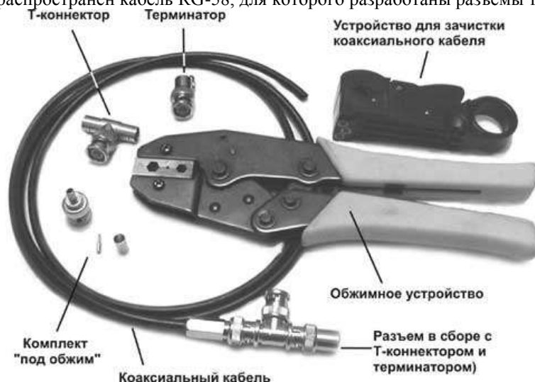
Рисунок 8 Инструменты и материалы, необходимые для оконцовывания коаксиального кабеля.
