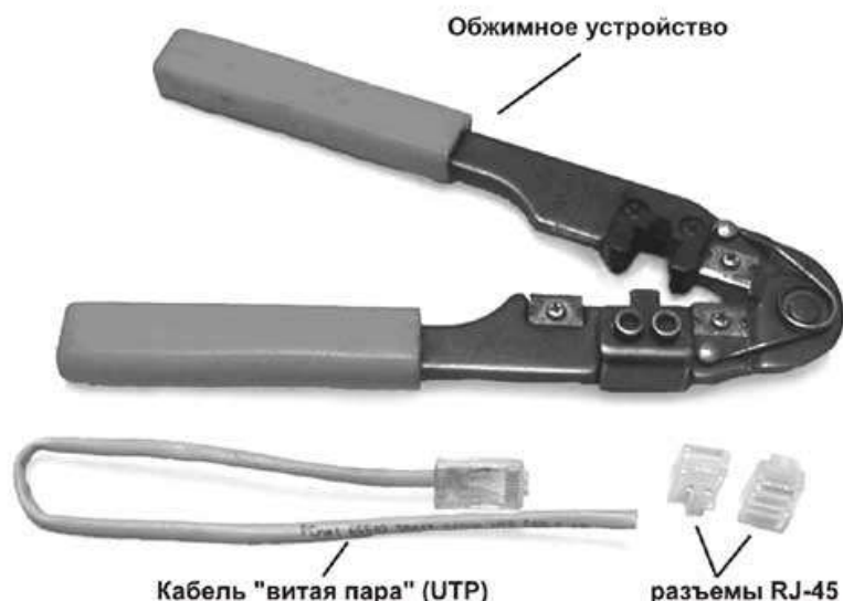
Рисунок 1. Инструменты и материалы, необходимые для установки разъемов на витопарный кабель
