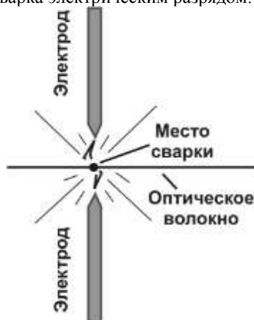
Рисунок 15. Принцип сварки оптического волокна.
