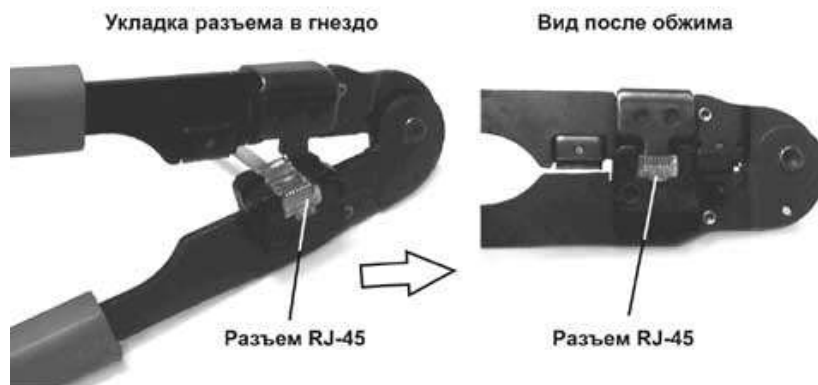
Рисунок 5. Обжим разъема RJ-45.
