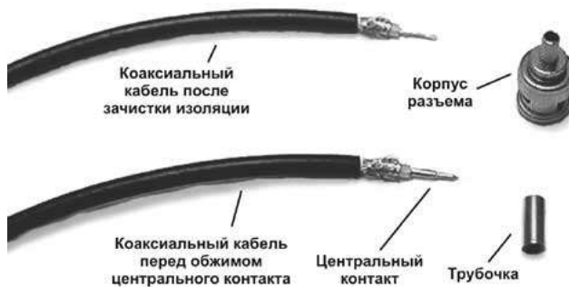
Рисунок 10. Вид кабеля после зачистки изоляции.
