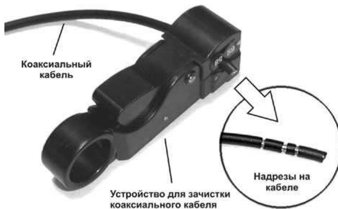
Рисунок 9. Надрезание изоляции коаксиального кабеля
