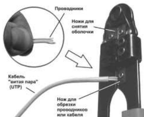
Рисунок 4. Выравнивание проводников перед введением в разъем.
