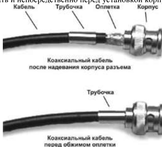
Рисунок 12. Разъем перед обжиманием оплетки.
