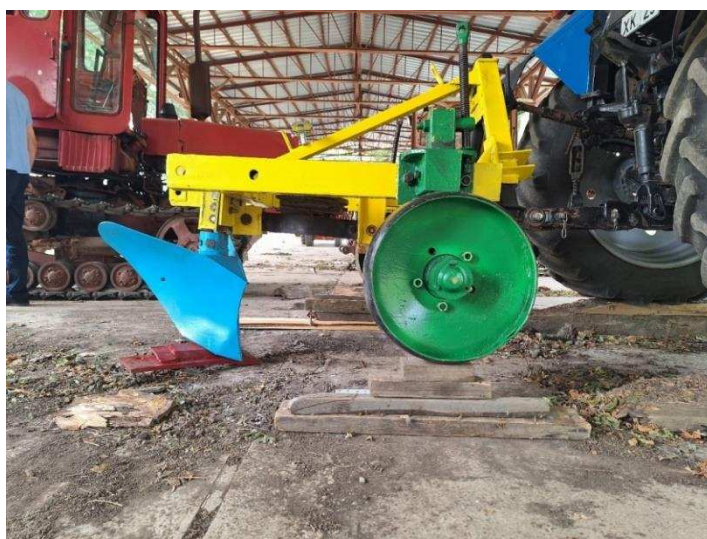
Рисунок 3.4 – Изображение регулировки глубины обработки рабочим органом
