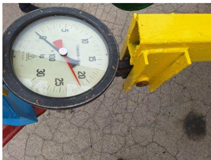
Рисунок 3.6 – Изображение закрепленного динамометра в экспериментальной установке
