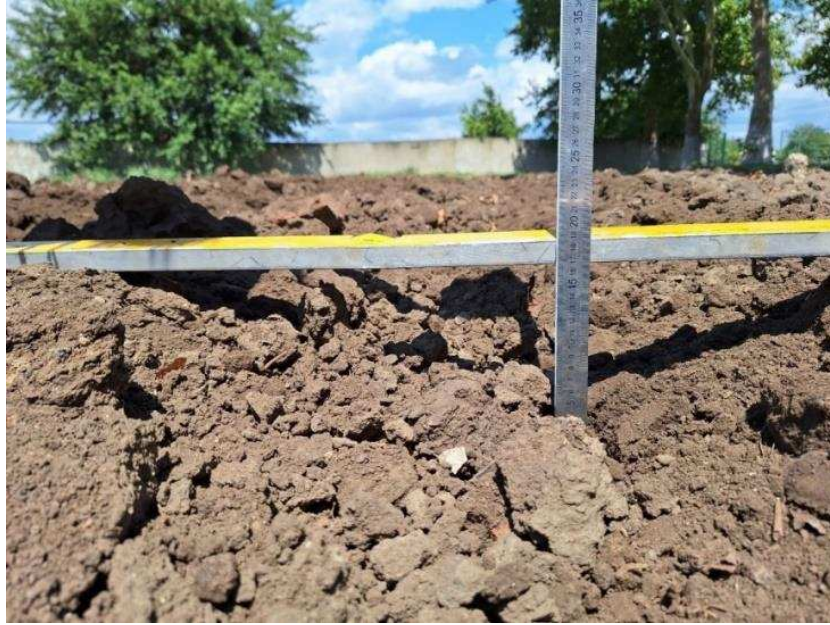
Рисунок 3.15 – Изображение определения равномерности глубины обработки и глыбистости
