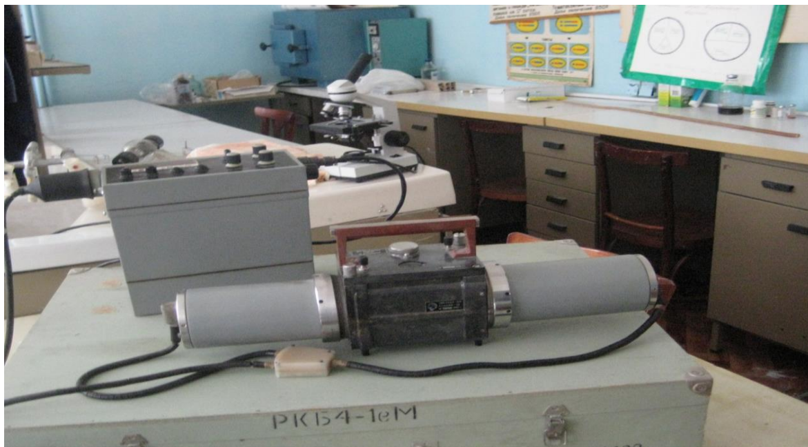
Рисунок 7 – Бета-радиометр РКБ4-1еМ, предназначенный для экспрессных измерений методом непосредственной оценки удельной и объемной активности бета-излучающих радионуклидов проб объектов внешней среды
