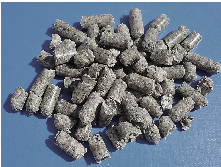
Рисунок 51 – Кормовая добавка из скопа, полученная из отходов целлюлозы
