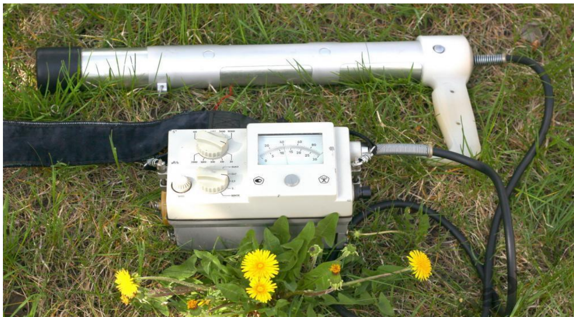
Рисунок 6 – Дозиметр радиометр гамма-излучений СРП-68-01 для измерения мощности дозы гамма-излучения
