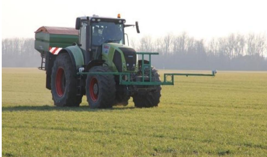
Рисунок 4.3 – Агрегат для дифференцированного внесения удобрений (трактор Claas Axion 850 с разбрасывателем Amazone ZA TS 4200 и азотным сканером GreenSeeker)
