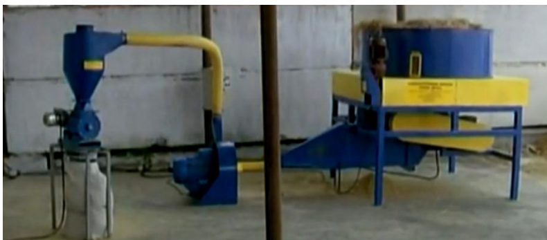
Рисунок 2 – Линия измельчения соломы
