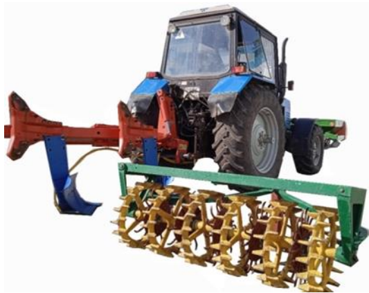
Рисунок 2 – Экспериментальная установка с колесным трактором: а – вид сзади; б – корпуса с системой подачи удобрений при вспашке
