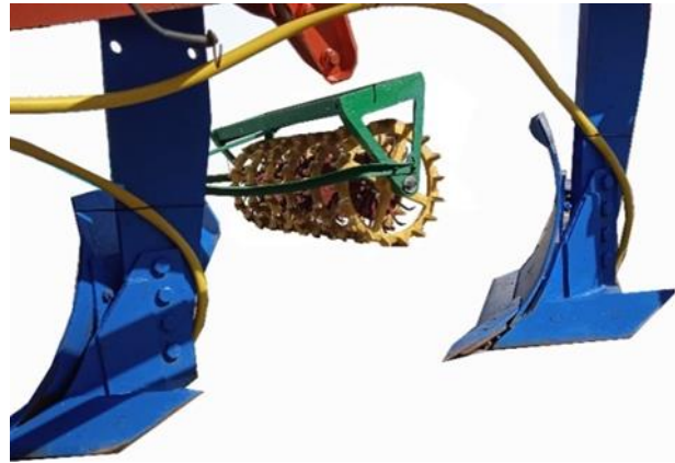
Рисунок 2 – Экспериментальная установка с колесным трактором: а – вид сзади; б – корпуса с системой подачи удобрений при вспашке
